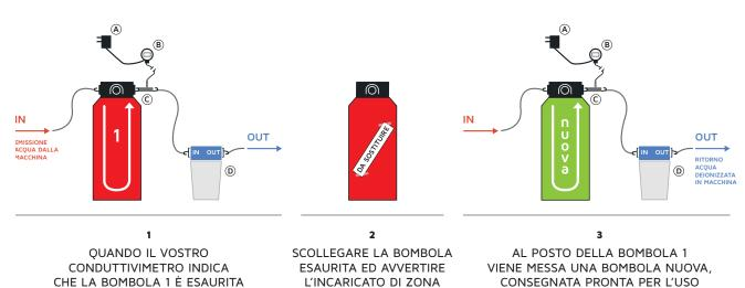
\* È NECESSARIO CONTROLLARE PERIODICAMENTE A VISTA LA CARTUCCIA FILTRANTE E SOSTITUIRLA QUANDO DIVENTA SCURA
